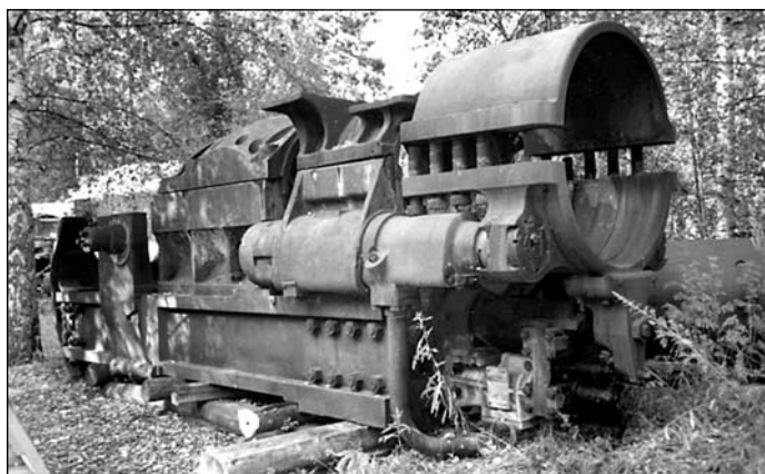
Станок 12-дм орудия в коллекции частного музея Хейкки Похьолайнен в Хювинкяа (Финляндия). Хорошо видна конструкция станка (Предоставлено Колин Партридж (Великобритания))
